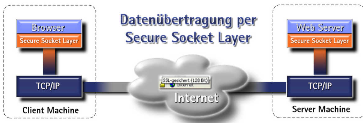
Abbildung 25 – Datenübertragung via SSL (Ausschnitt)
