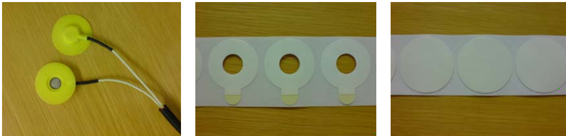
Abbildung 2: Unterwasserelektroden, Klebriinge und wasserabweisende Schaumstoffriinge
