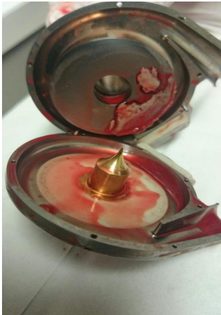
Abb. 12 Thrombusbildung in einem HVAD nach erfolgter Explantation. Mit freundlicher Genehmigung von Prof. Dr. Schmitto aus dem Institut für Herz-, Thorax-, Transplantations- und Gefäßchirurgie der Medizinischen Hochschule Hannover.
