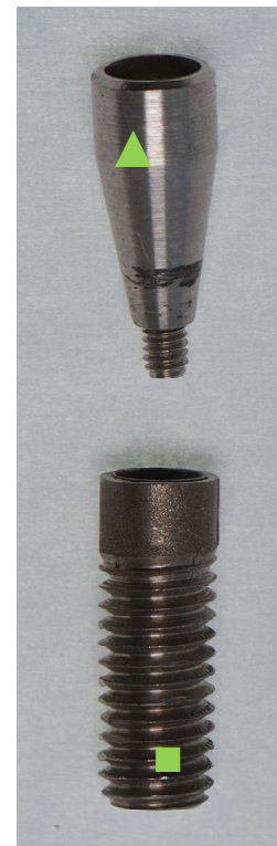
Abbildung 7 - Prototyp eines Implantats aus UFG-Nb bestehend aus Implantatfixtur (■) und experimentellem Abutment (▲).
