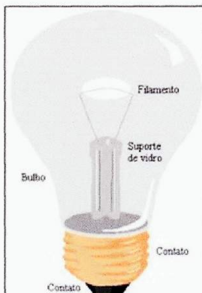
Figura 21 – Estrutura de uma lâmpada incandescente. (fonte: http://www.contra-ataque.com/forum/lofiversion )
